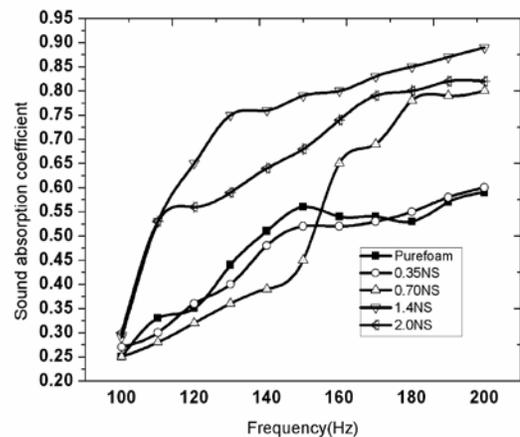
Fig. 8a PU foam with NS
