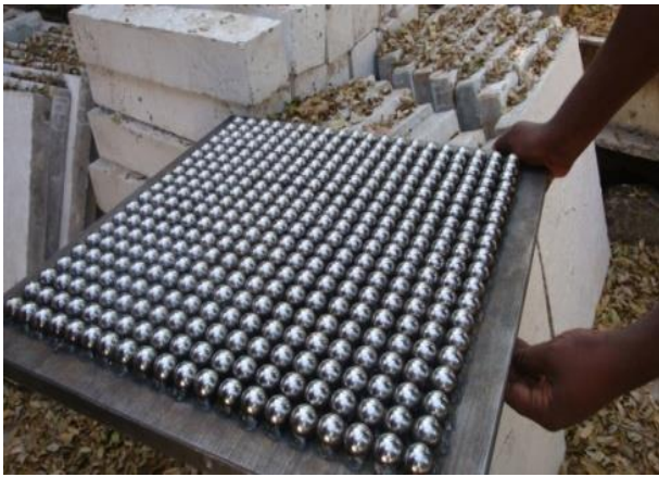
Plate. 2. UDL Slab Pattern
