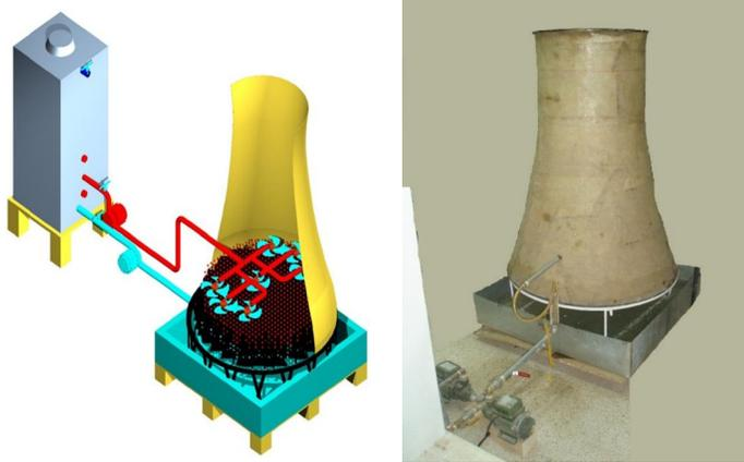
Fig. 2 a- Test rig using WDDAF b- Actual rig
